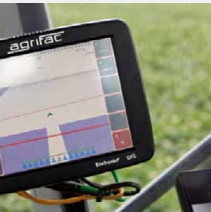
Der GPS-Screen zeigt standardmässig die Spritzbreite an.
