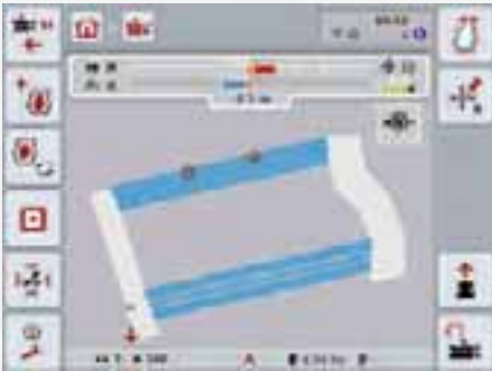
Die Software-Komponente Command (PT) von TurnControl Pro Guide ermöglicht die Pflugarbeitsbreitensteuerung via GPS.
