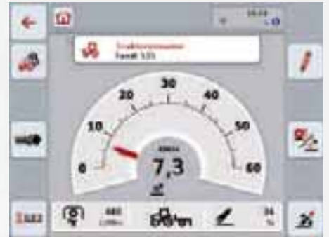
Die TECU (Tractor electronic control unit) von Lemken TurnControl Pro ist Voraussetzung für die Steuerung von Fahrgeschwindigkeit, Hubwerkposition und Flächenerfassung.
