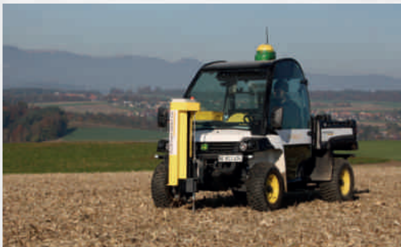
Die Geländefahrzeuge sind mit Bodenprobenstecher und GPS ausgerüstet. Les véhicules agricoles sont équipés d'un préleveur de sol et d'un GPS.
