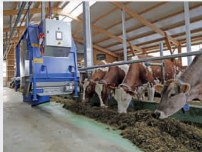
Der Bauer muss mit dem Roboter nur noch die Futterkomponenten in den Mischer füllen. Den Rest erledigt die Maschine.
